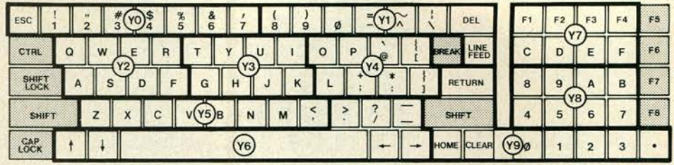
Figuur 2. Zo worden alle toetsen van een alfanumeriek toetsenbord met een apart numeriek gedeelte ingedeeld in groepen voor de 10 rijen van de matrix. Dit is slechts een voorbeeld, men kan ook een andere indeling kiezen.
